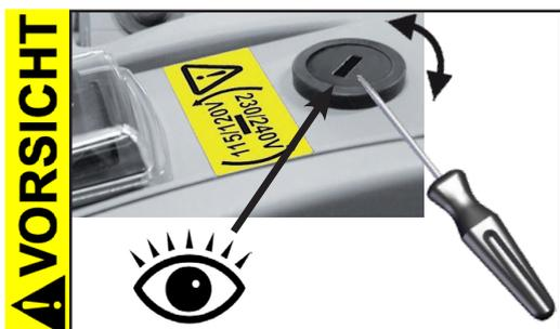
**Spannungsbereich am Spannungswahlschalter einstellen:**
